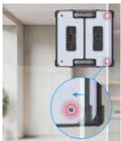
Tecnología detección de bordes por vacío Evita que el robot se caiga al detectar el borde
